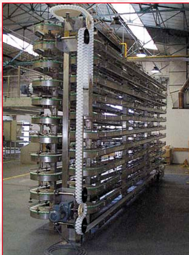
Conveyeur à chaînes de type LF couleur blanche avec guidages latéraux
