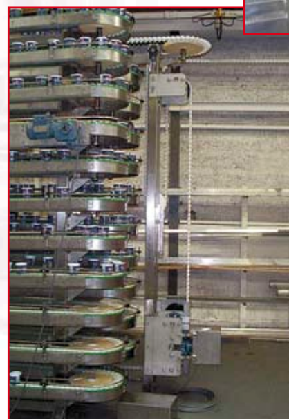
Conveyeur composé de 11 serpentines montantes et de 11 serpentines descendantes
