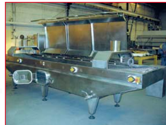
Partie supérieure du tunnel relevable manuellement.
