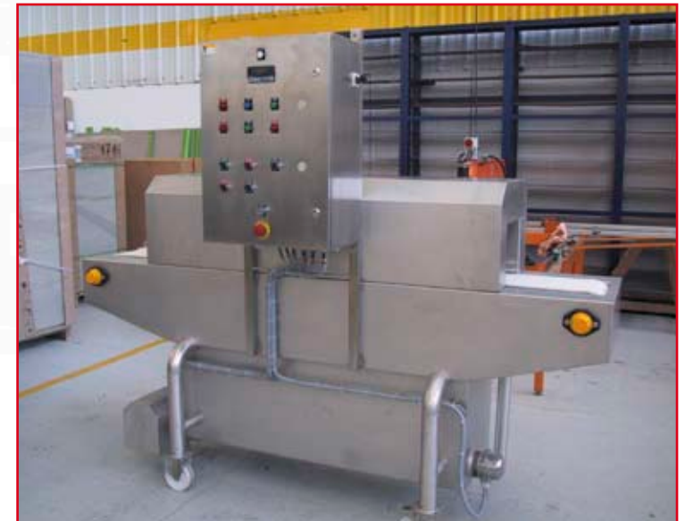
Avance des verrines par chaînes Intralox et variateur de vitesse
