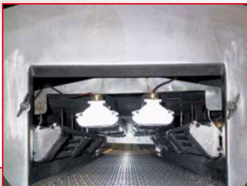
Infrarouges de type "IR Moyen" 24 radiants métalliques d'une puissance totale de 19,20 KW.
