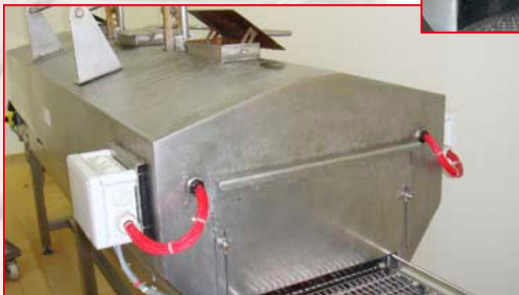
Tunnel de braisage équipé d'un tapis à maille en acier inoxydable AISI 304 L. Réglage en hauteur des infrarouges.
