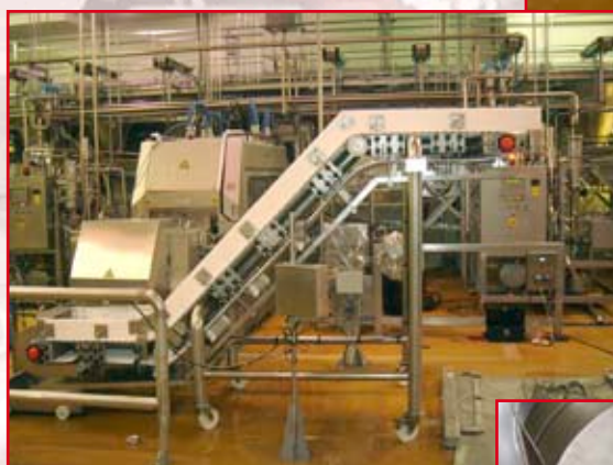
Ensemble de convoyeurs à bande Motorisation: tambours-moteur
