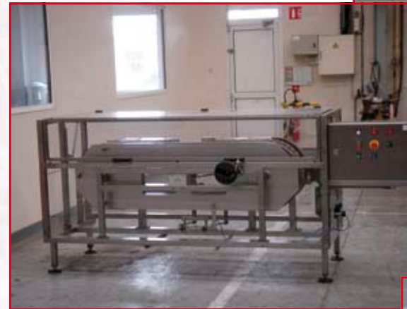
Retourneur souffleur par pincement et son armoire électrique
