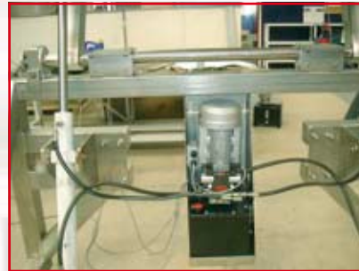
Centrale hydraulique pour pilotage des 2 vérins de basculement Sécurité absolue en cas de rupture des flexibles
