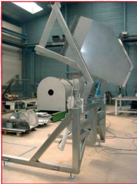
Châssis structure tubulaire 100 x 100 mécano-soudé Soudures étanches et alimentaires effectuées sous gaz neutre, décapées et passivées
