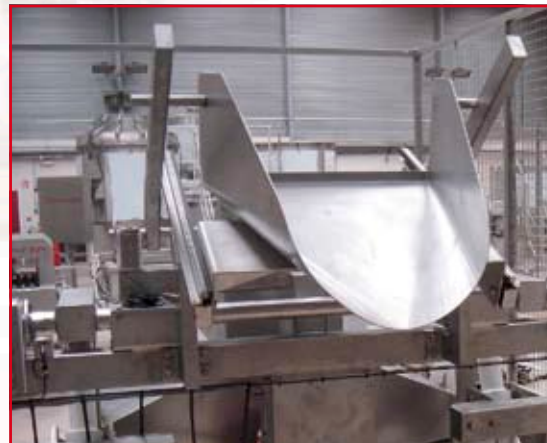
Goulotte de déversement mobile dans le cas de chargement frontal. Ce retourneur se déplace sur rails. Translation manuelle ou assistée par motoréducteur. Les axes de retournement sont largement dimensionnés et la rotation se fait dans des paliers HD1000.
