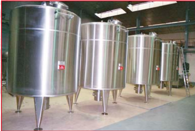
Volumes cuves: eau neuve 5 000 litres eau récupérée 5 000 litres soude 5 000 litres acide 5 000 litres
