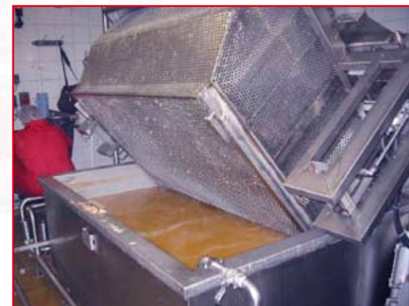
Chauffage par double enveloppe. Armoire de régulation de température Couvercle relevable manuellement avec charnières à action compensée.
