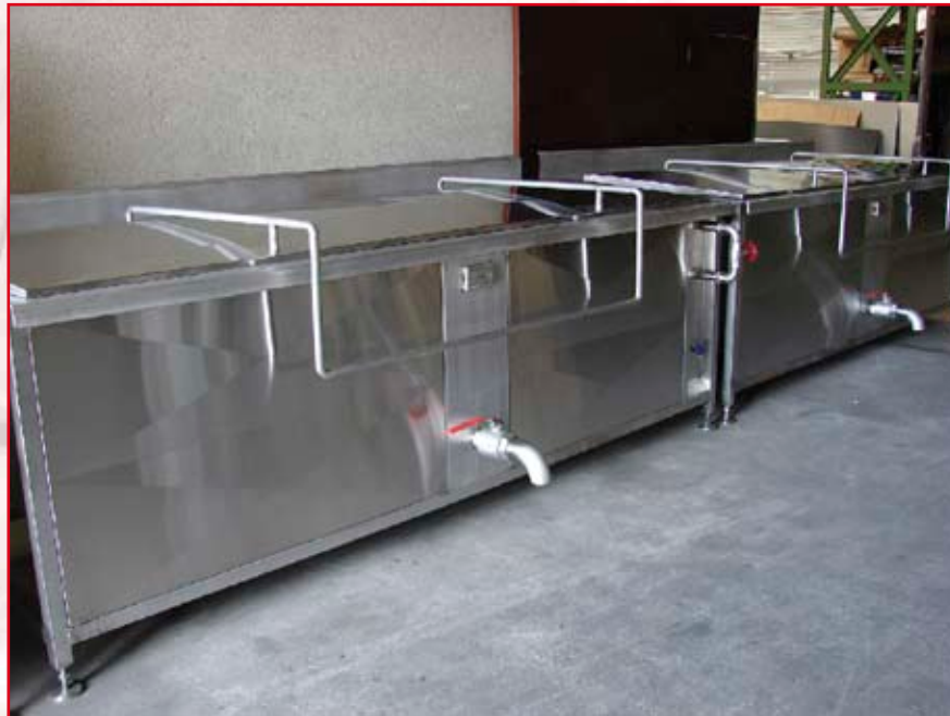
Chauffage par double enveloppe en nids d'abeilles
