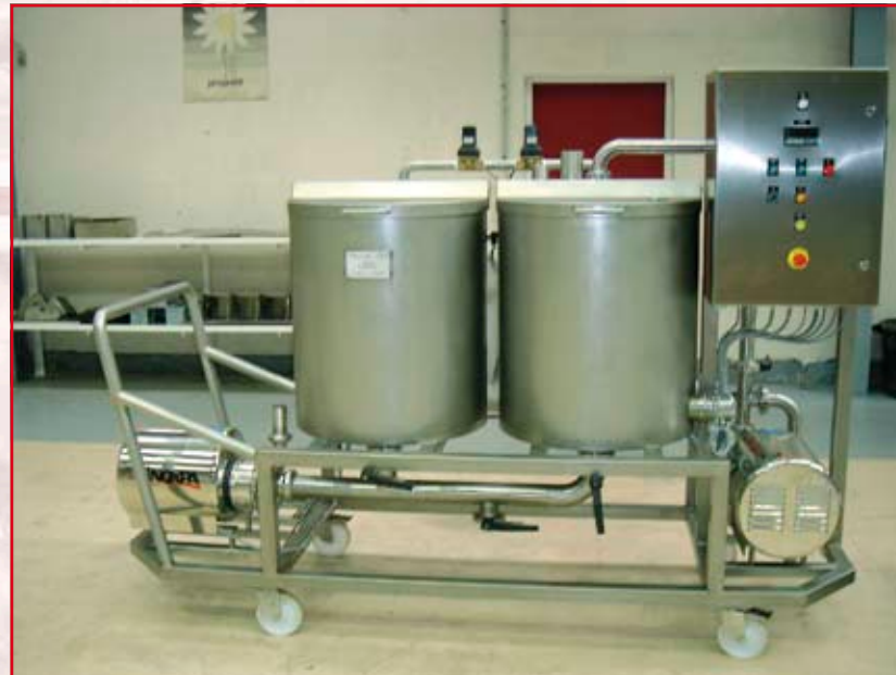
CIP mobile équipé de 2 pompes "envoi" et "retour" lavage
