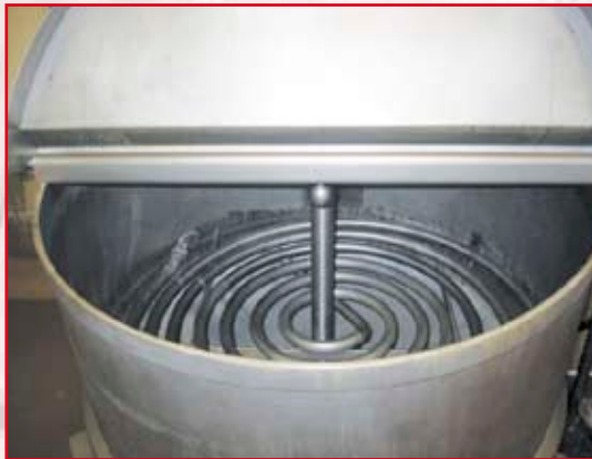
Chauffage par double enveloppe et serpentins de fonte Boule de lavage pour mise en circuit de nettoyage
