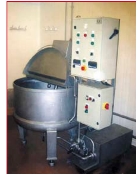
Coffret de commande électrique Régulation de température Système d'agitation avec variateur de vitesse
