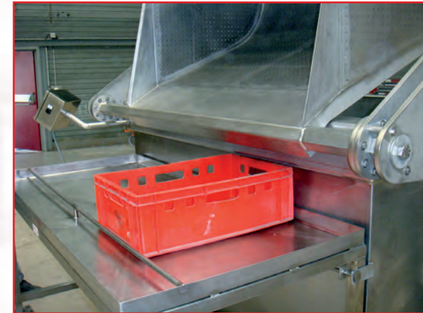
Déchargement dans bac europe, sur table de réception ou dans casse plastique
