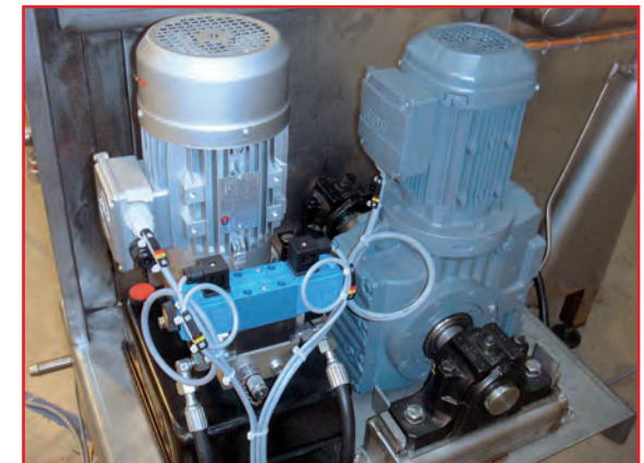
Basculement panier par système pneumatique ou hydraulique
