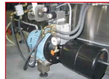
Mini centrale hydraulique pour ouverture couvercle et basculement panier
