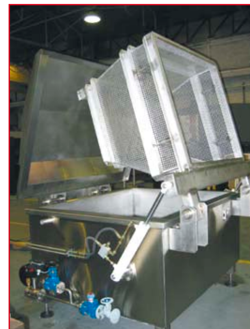
Panier réalisé en tôle perforée acier inoxydable 316 L
