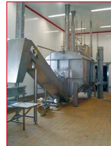
Récupération des jus de cuisson pour réintégration ou évacuation
