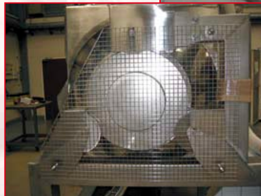
Cartérisation des organes de basculement avec grille de sécurité
