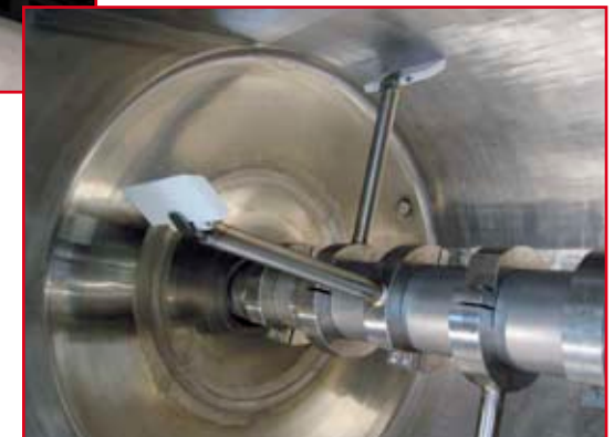
Bras d'agitation équipé de racleurs démontables
