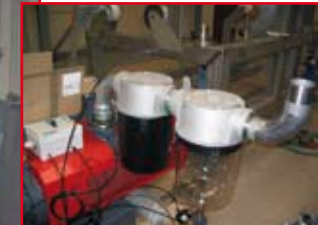
Pompe à vide équipée d'un purgeur et d'un piège à liquide
