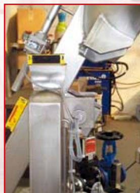
Couvercle relevable manuellement par contrepoids
